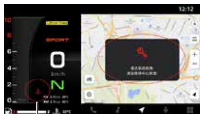
Spia malfunzionamento radar
