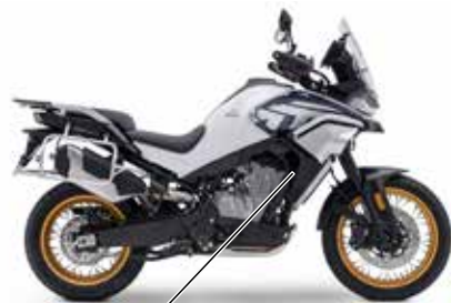
Posizione serbatoio liquido refrigerante
