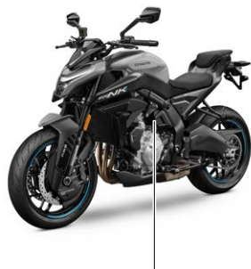
Ubicazione presa di corrente
