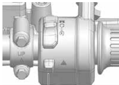
Segnalazione di emergenza (Hazard)
