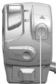
Segnalazione di emergenza (Hazard)
